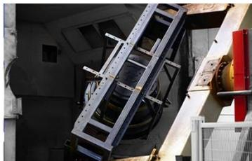
L'ensemble moule matière, est mis en mouvement, le moule tourne alors dans toutes les directions, et la poudre de matière plastique ruisselle par gravité sur les parois. Les vitesses de rotation étant faibles l'effet de la force centrifuge est négligeable.
